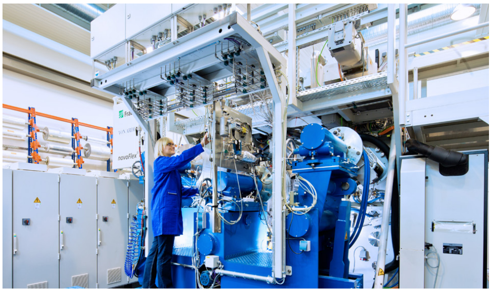
Rolle-zu-Rolle Beschichtungsanlage für die Entwicklung von Funktionsschichten auf flexiblen Materialien Quelle: Fraunhofer FEP, Fotograf: Jürgen Lösel
