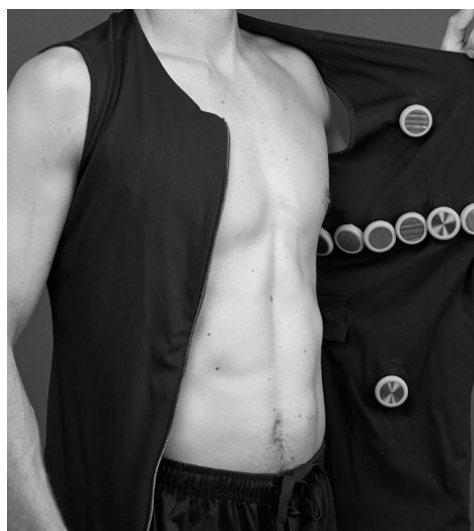
12-lead EKG-Holter System. Prototyp der kooperativen Sensortechnologie im Rahmen einer klinischen Studie zur Vergleichsmessung mit dem medizinischen Goldstandard eines 12-lead EKG-Holters. Quelle: CSEM
