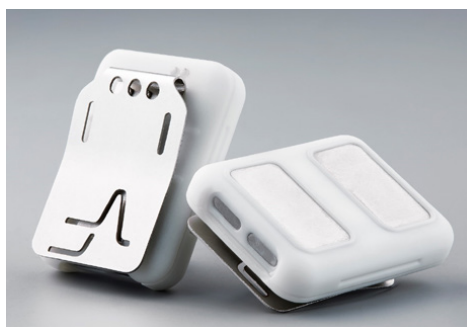
Vexavit kommerzialisiert die kooperative Sensortechnologie mit dem Produkt VX-II, mit der drahtlosen Übertragung der Vitaldaten eines 1-lead EKG, der Atmungsfrequenz und der Körperbewegung. Quelle: www.vexavit.com
