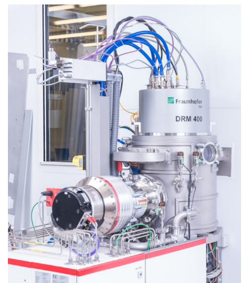
Doppel-Ring-Magnetron-Sputterquelle für reaktive Magnetron-Sputterverfahren für piezoelektrische Schichten Quelle: Fraunhofer FEP, Fotograf: Ronald Bonß
